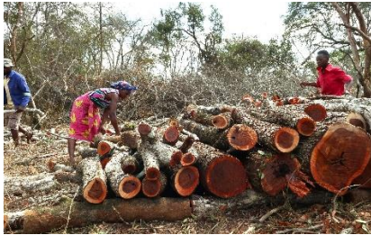
Figura 34b. Empilhamento transversal de um forno feito exclusivamente com Newtonia hildebrandtii . Djabula, foto F. Zacarias (2021)
