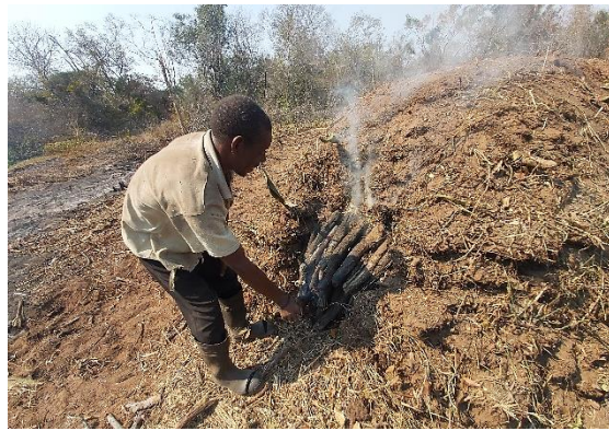
Figura 34e. Ignição do forno ('tabica'). Djabula, foto F. Zacarias (2021)
